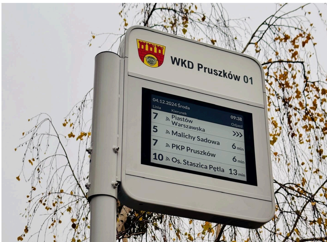
Zdjęcie. Tablica dynamicznej informacji pasażerskiej
